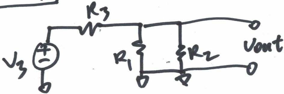
$$V_{out3} = V_3 \cdot \frac{R_1 \parallel R_2}{R_3 + R_1 \parallel R_2}$$
