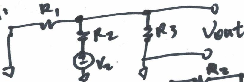
$$V_{out_2} = V_2 \cdot \frac{R_1 // R_3}{R_2 + R_1 // R_3}$$
