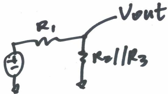
$$V_{out_1} = V_1 \cdot \frac{R_2 // R_3}{R_1 + R_2 // R_3}$$
