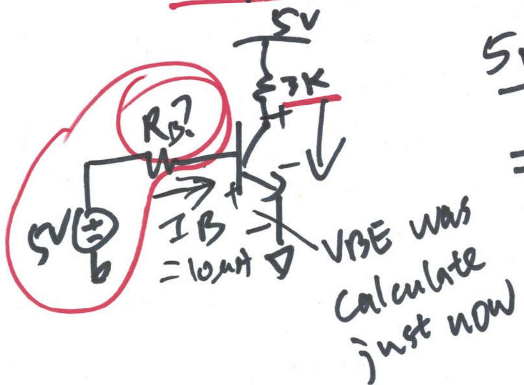
$$\frac{5V - V_{BE}}{R_B} = 10\mu A$$
